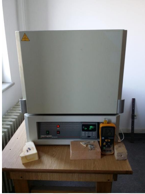
Fotoğraf 4.3. PROTHERM (Model PTF 12/75/200) programlanabilir kül fırını
