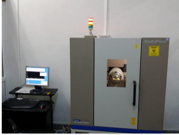
Fotoęraf 4.4. Rigaku MultiFlex 2kW X-Işını kırınım ölçeri
