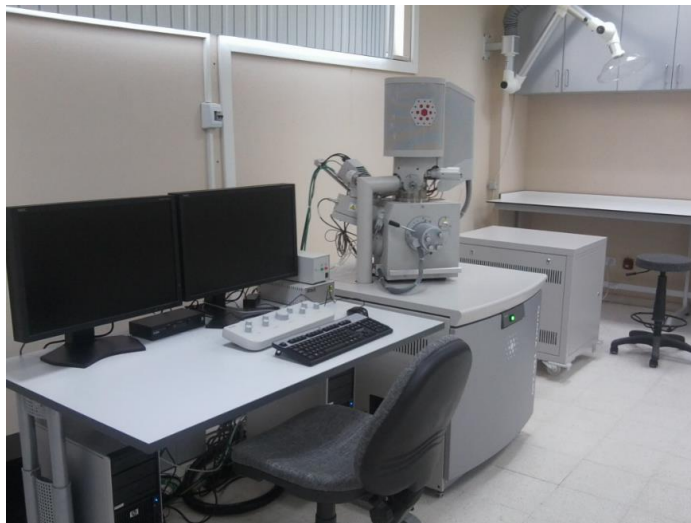
Fotoęraf 4.5. FEI Quanta FE-250 20 kV Taramalı electron mikroskobu
