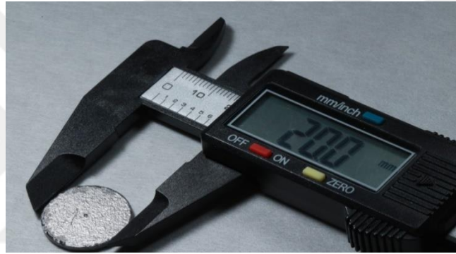
Şekil 3.13. Dijital kumpas ile örnek boyutlarının ölçümü
