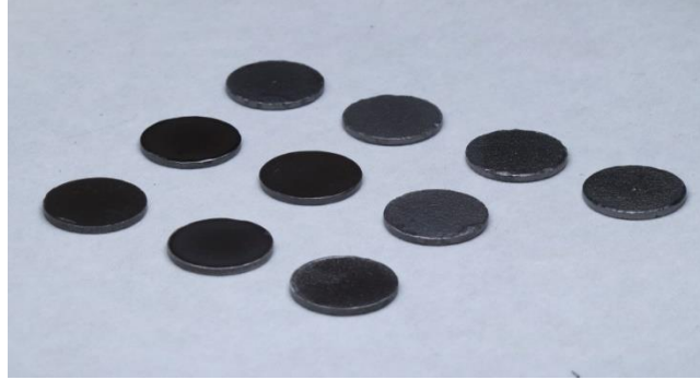
Şekil 3.12. Sinterleme sonrası test grubu örnekleri
