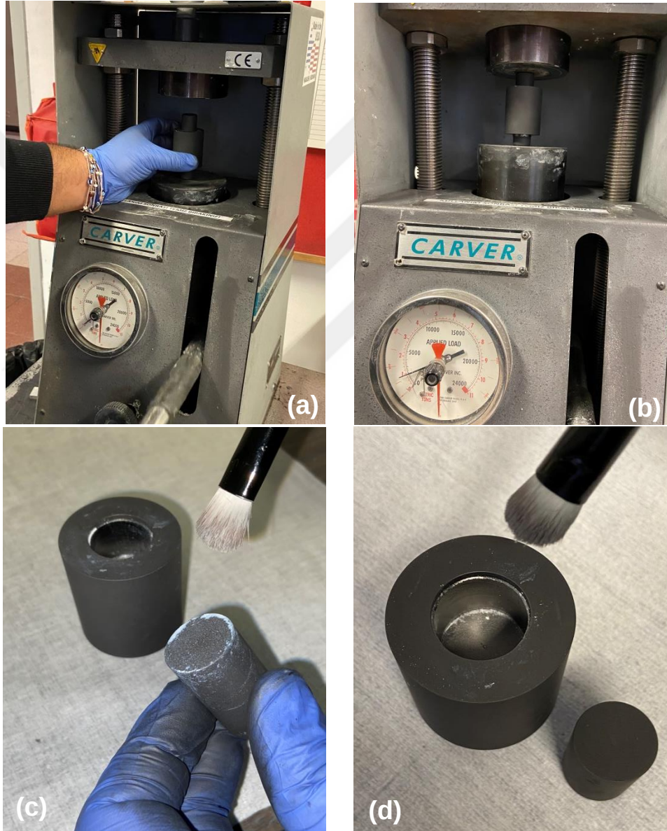
Şekil 3.9. (a) Kalıp setine aksiyal presleme uygulanması, (b) Aksiyal presleme ile uygulanan basınç değeri görüntüsü, (c) Presleme sonrası toz kaçışının izlenmesi, (d) Kalıp yüzeyine yapışan tozların fırça ile uzaklaştırılması
