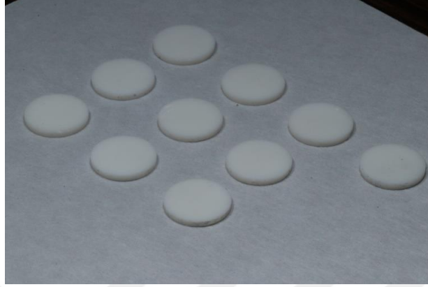
Şekil 3.4. Sinterleme sonrası kontrol grubu örnekleri
