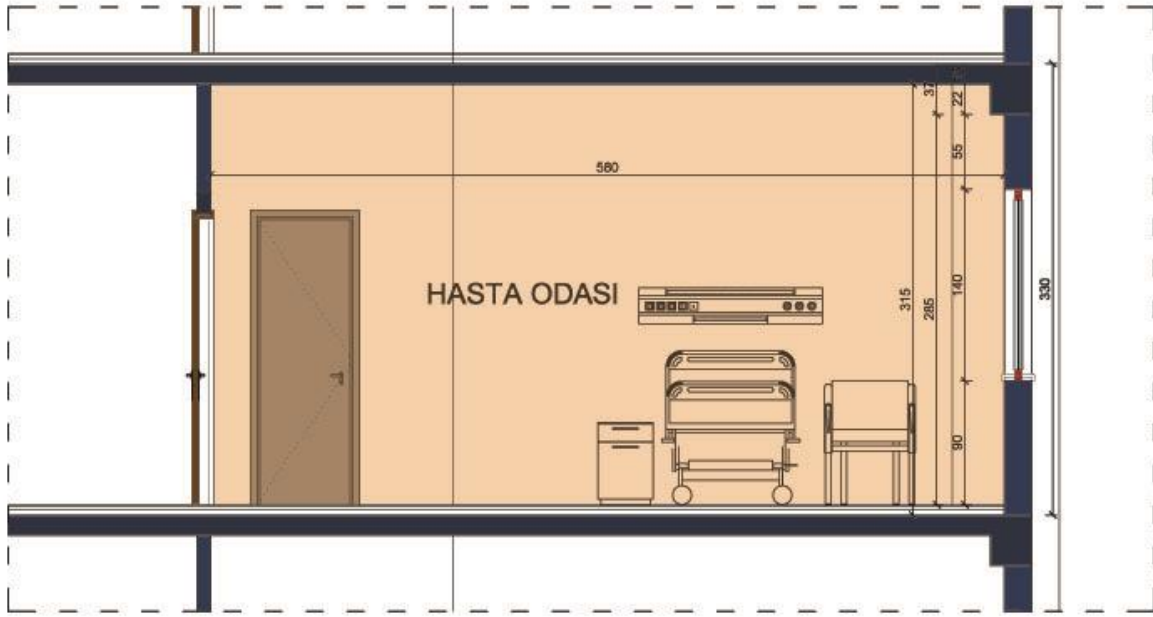
Şekil 3.3. Hasta odasının kesiti (G.Ü. Yapı İşleri ve Teknik Daire Başkanlığından alınan CAD dosyası üzerinden yazar tarafından yeniden çizilmiştir)
