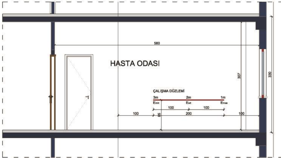
Şekil 3.8. Hasta odasında simülasyonlarda hesaplamaların yapıldığı çalışma düzlemi (yazar tarafından hazırlanmıştır)
