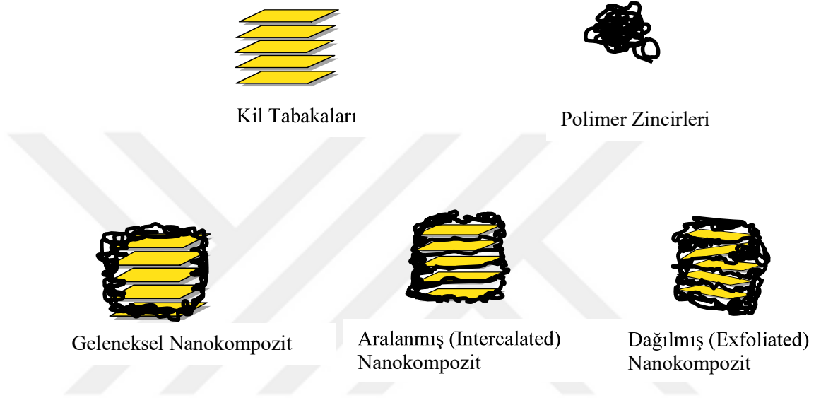
Şekil 2.9. Polimer/kil nanokompozit yapıları
