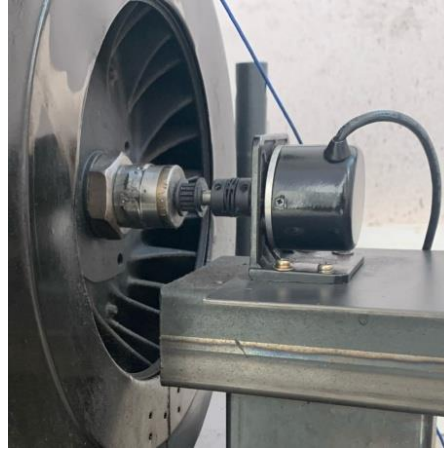
Şekil 2.8. Deney motoruna enkoderin bağlanmış hali
