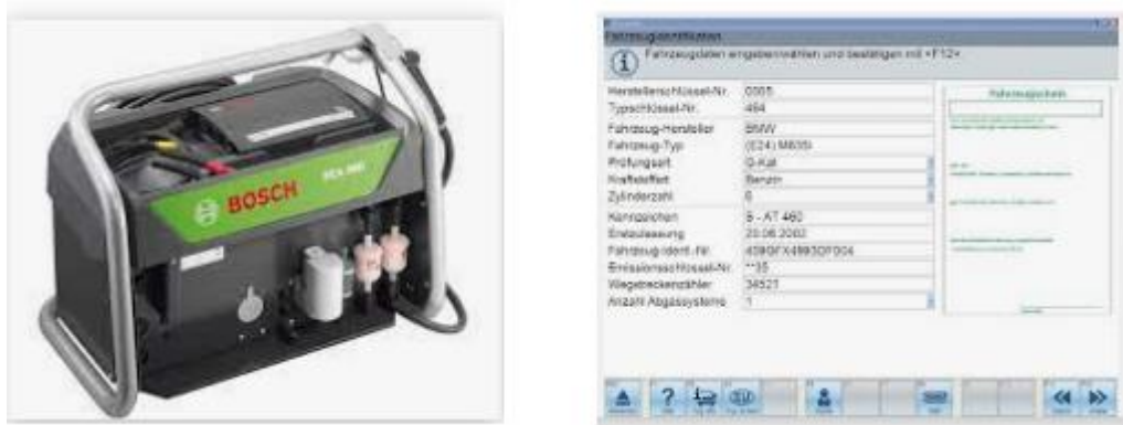
Şekil 2.9. Egzoz emisyon cihazı ve ölçüm için kullanılan arayüz
