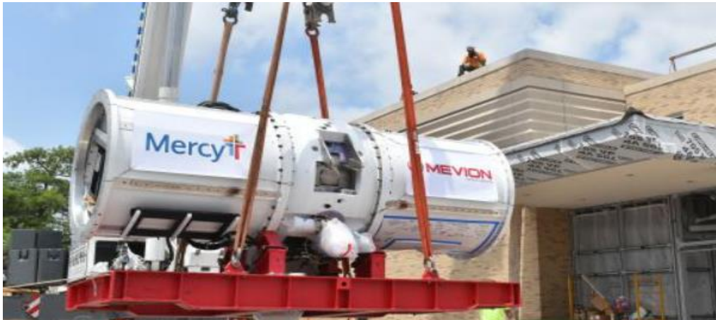
Şekil 18. MEVION S250i model 15 tonluk dünyanın en küçük kompakt proton terapi hızlandırıcısı.
