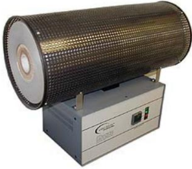
Şekil 3.9 Vecstar VCTF-4 difüzyon fırını 0-1200 °C
