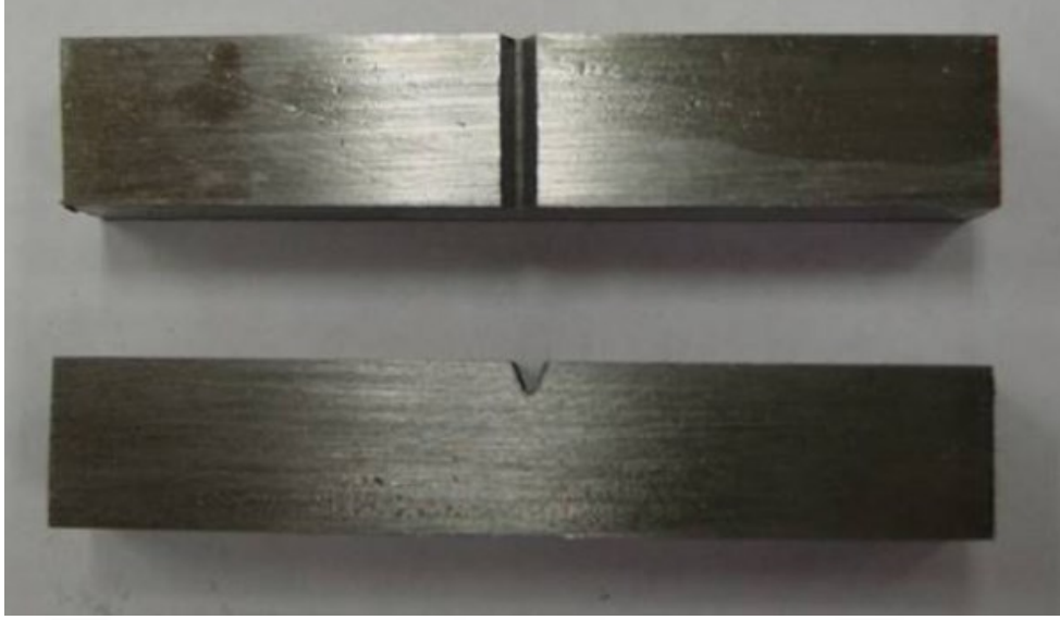
Şekil 4.11. Çentik-darbe testi için hazırlanan numunenin görseli.
