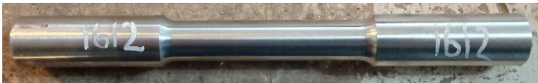
Şekil 4.7. Akma-çekme testi için hazırlanan numunenin görseli.
