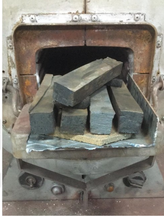
Şekil 4.4. Numunelerin ısıtılma fırınına yerleştirilme şekli.
