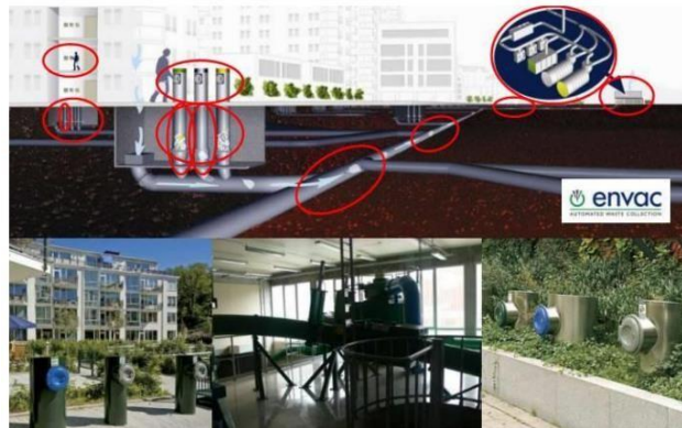
Görsel 3.34. Hammarby’de vakumlu ayrıştırılmış katı atık toplama sistemi
