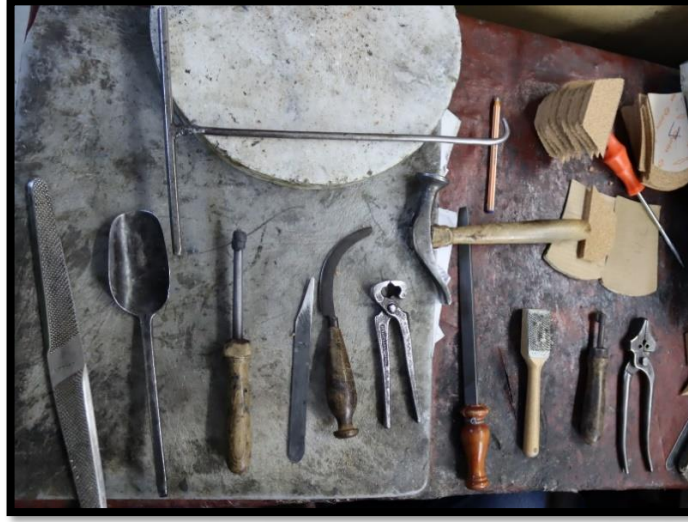
Şekil 96: Soldan sağa; raspa, fora kaşığı, masat, falçata, törpü, kerpeten, eğ, tırpan, çark, danalya, çekiç (ortada), kanca(üstte).
