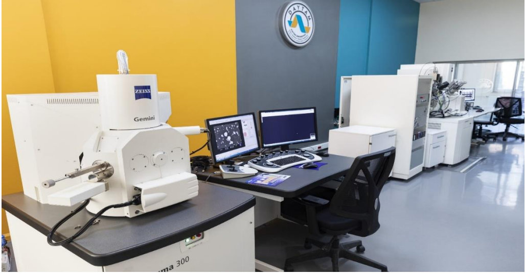
Şekil 34. SEM- EDAX cihazı (DAYTAM, 2022)
