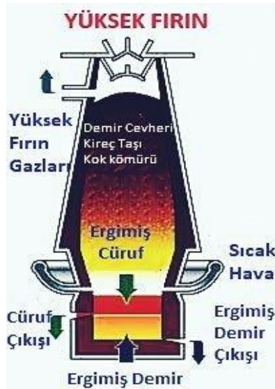
Şekil 5. Yüksek fırın cürufunun üretimi (Şengül vd., 2007)
