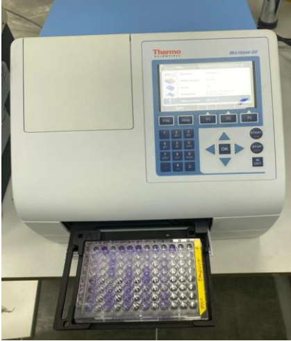
Şekil 4.7: Suşların biyofilm oluşumunun kristal viyole ile boyanması ve Spektrofotometre cihazında OD ölçümü ile değerlendirilmesi
