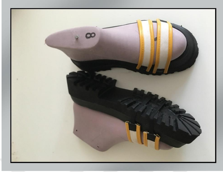
Şekil A.15. EVA taban, pet şişeden geri dönüşüm iplik ile dokuma bantlı terlik. Taban üzerine bantlar ile farklı formlar oluşturulmaktadır
