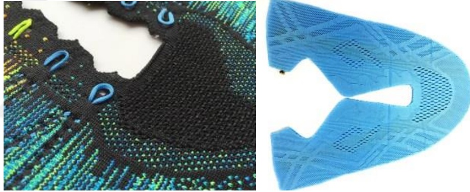
Şekil 4.23. CNC makinesinde üretilen örme saya
