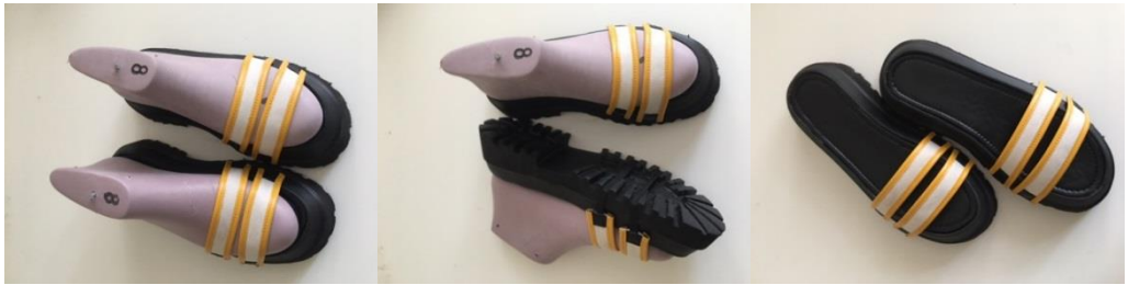
Şekil 9.48. EVA taban üzerinde sayası pet şişe geri dönüşüm dokuma materyal ile bantlı terlik
