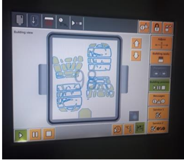
Şekil 9.27. Sinterleme işleminde tabanın ekran görüntüsü, üretim aşaması
