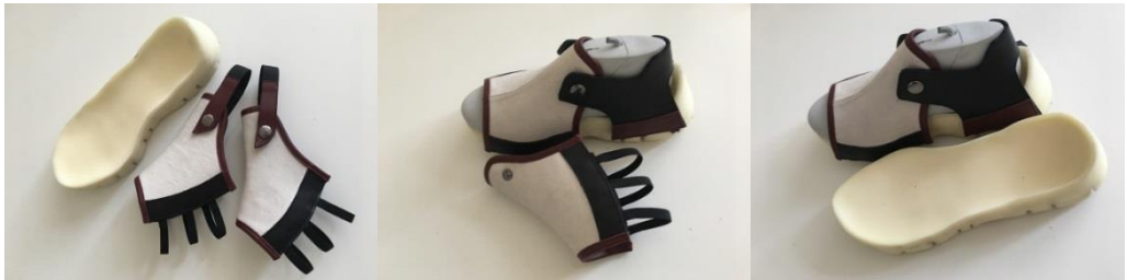
Şekil 9.43. PEBA taban üzerinde sayası dokuma ( pet şişe) geri dönüşüm malzemesi
