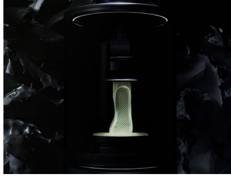
Şekil 5.19. Digital Light Synthesis (DLS) sistem ile Adidas 4D taban
