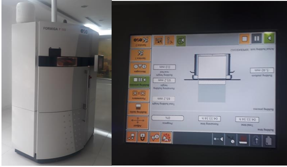
Şekil 9.25. Formiga P 110 SLS makinesi ve ekranı (Üretim ölçü ve çalışma paneli)
