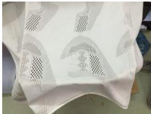
Şekil 4.24. CNC makinesinde üretilen 90cm. örme delikli saya
