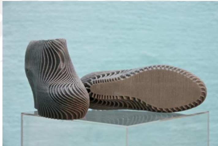
Şekil 5.16. Filaflex filament ile üç boyutlu yazıcı tasarımı
