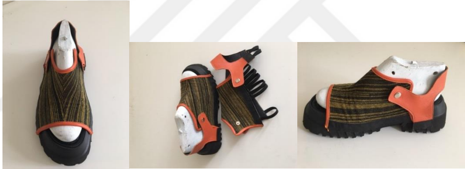
Şekil 9.51. EVA taban üzerinde sayası pet şişe geri dönüşüm örme materyal ile sandalet
