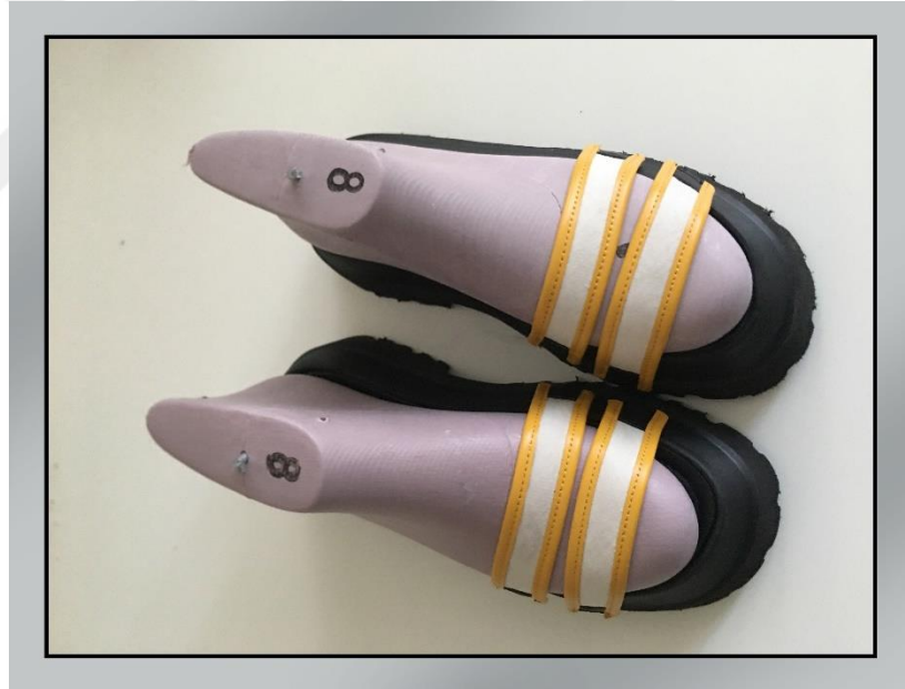
Şekil A.16. EVA taban, pet şişeden geri dönüşüm iplik ile dokuma bantlı terlik
