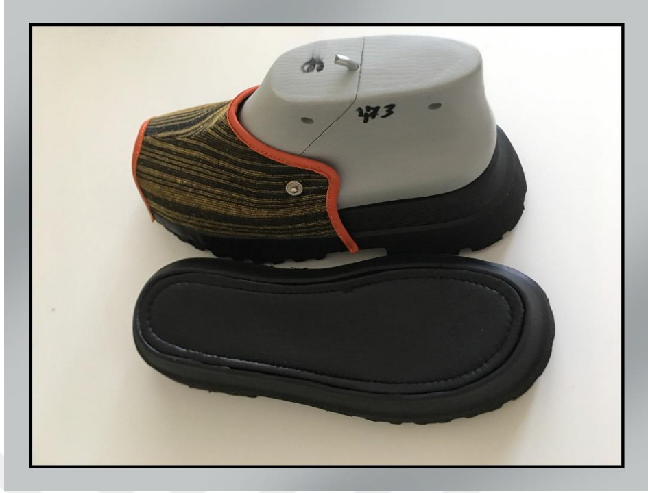
Şekil A.11. EVA taban, geri dönüşüm iplik ile örme saya
