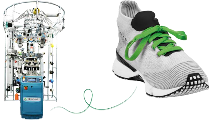
Şekil 5.15. Santoni saya örme makinesi ve örülen saya ile üretilmiş spor ayakkabı
