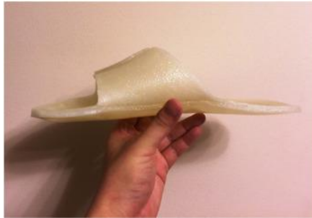
Şekil 6.8. Sun ve arkadaşları tarafından geliştirilen şekil hafızalı terlik prototipi
