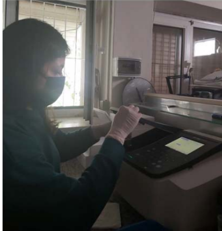
Şekil 3.11. Spektrofotometre ile C Vitamini Ölçümü.
