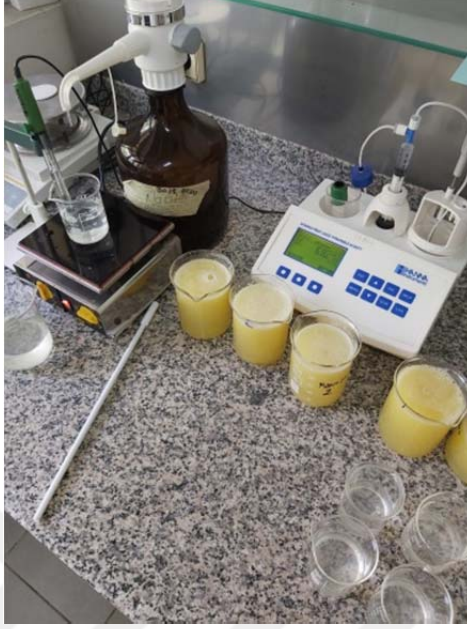
Şekil 3.9. Küt diken limonlarında asitlik titrasyonu işlemi.
