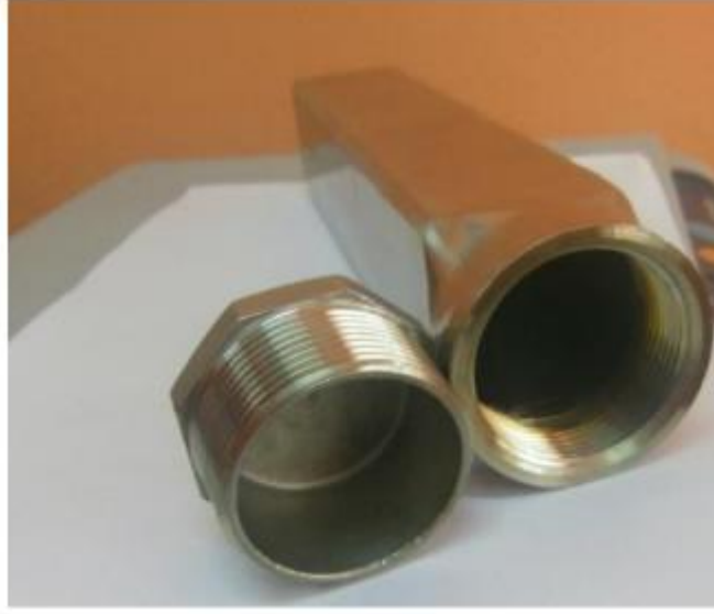
Resim 4.1. Borlama işleminde kullanılan paslanmaz AISI 321 çeliğinden imal edilmiş borlama potasının görünümü
