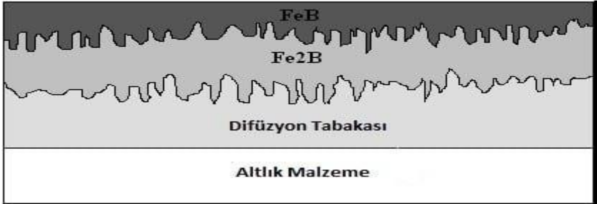
Şekil 3.2. Bor tabakası, geçiş bölgesi ve ana yapının şematik resmi (Taşçı,1993)
