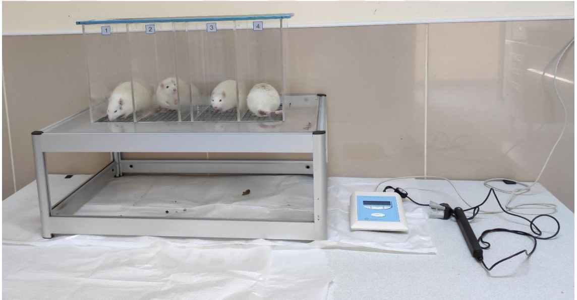
Şekil 3.3.1. Elektronik Von Frey Cihazı ve Pleksiglas Kafesler
