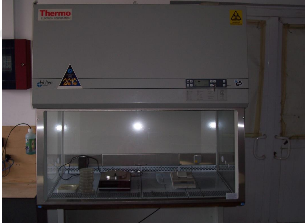
Şekil 3.7. PM tartım kabini
