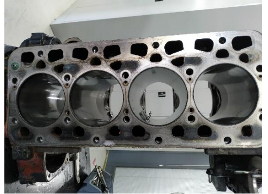
Şekil 4.12. B20 (sol) ve dizel yakıt (sağ) kullanılan silindir cidarları
