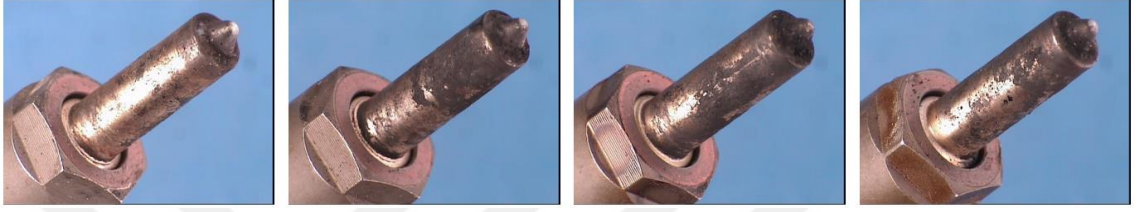
Şekil 4.20. Dizel yakıt ile çalışma sonrası 1, 2, 3 ve 4 numaralı meme gövdesi (temizleme öncesi)
