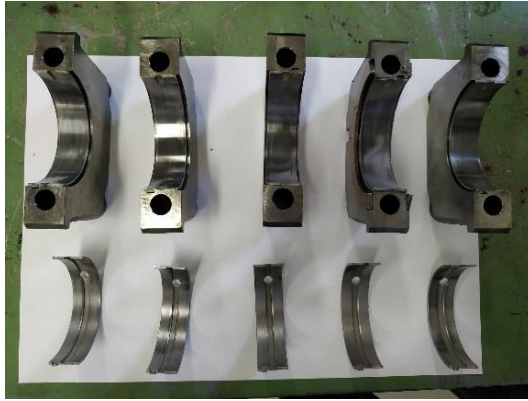
Şekil 4.9. B20 (sol) ve dizel yakıt (sağ) kullanılan krank mili yatakları
