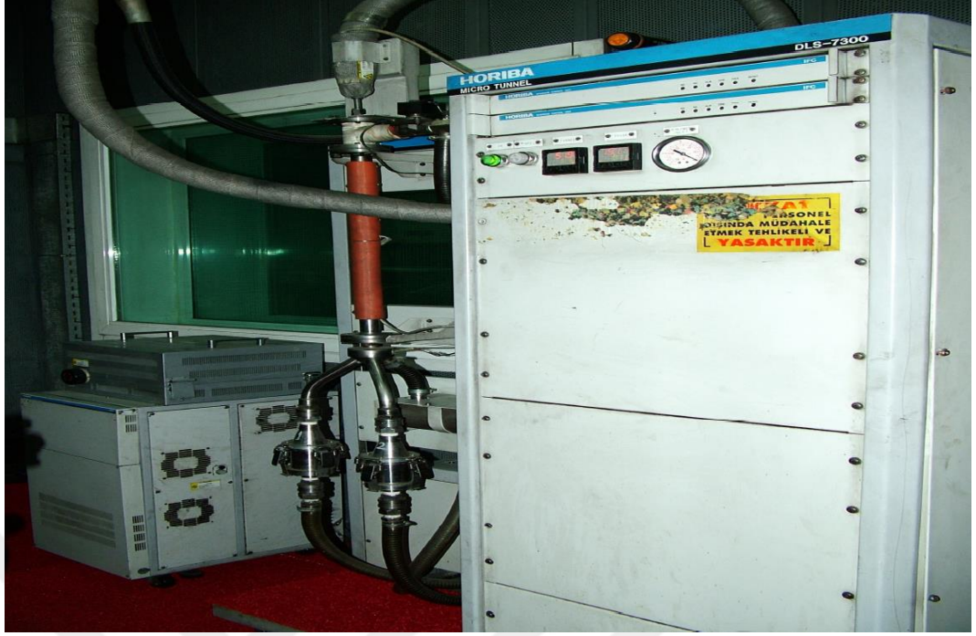
Şekil 3.6. Egzoz emisyon ölçüm cihazı
