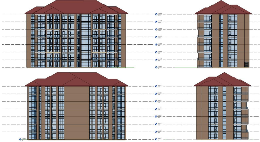
Şekil 5.10: Oluşturulan BIM modelinin ön cephe, arka cephe ve yandan görünümü.
