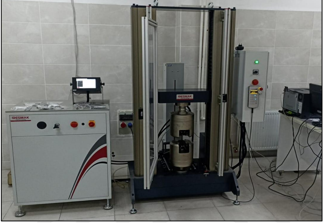
Şekil 5.14 BMT-5E Serisi 50 KN Kapasiteli Servo Elektromekanik Universal Test Cihazı
