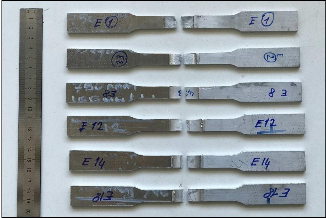
Şekil 6.5 Çekme Deneyi Sonrası Kopan Numune Örnekleri
