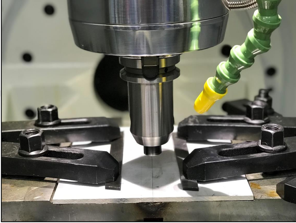
Şekil 5.7 Sürtünme Karıştırma Kaynağı Öncesi Görünüm
