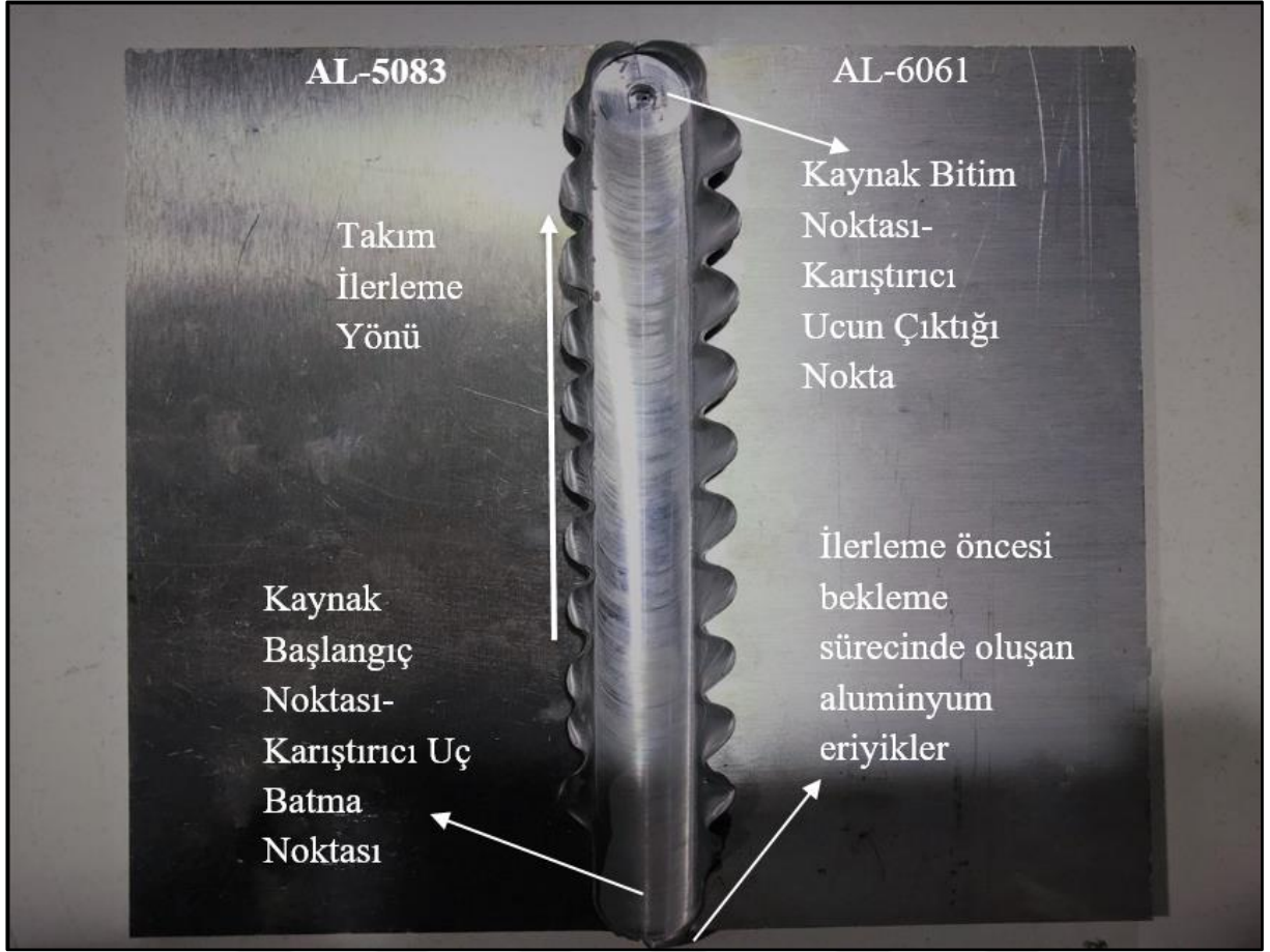
Şekil 5.8 Kaynak Sonrası Birleştirilmiş Levhaların Görünümü
