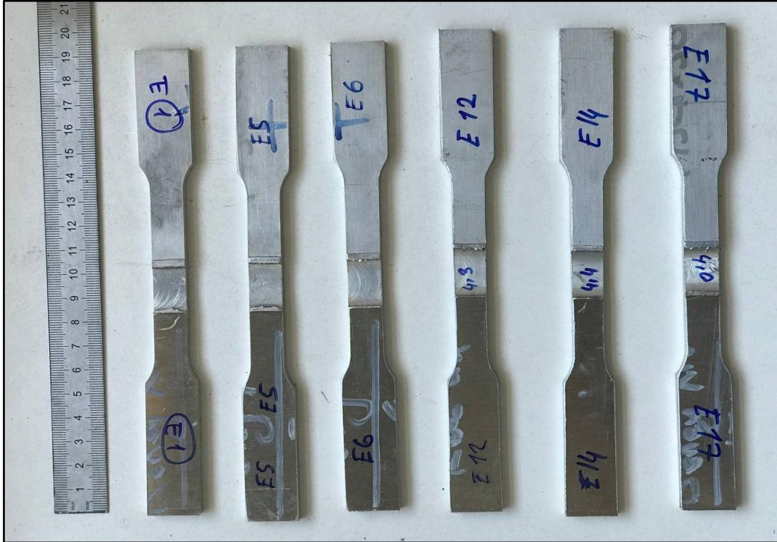
Şekil 5.13 ASTM E-8 Standartlarında Lazer ile Kesimi Yapılan Çekme Çubukları
