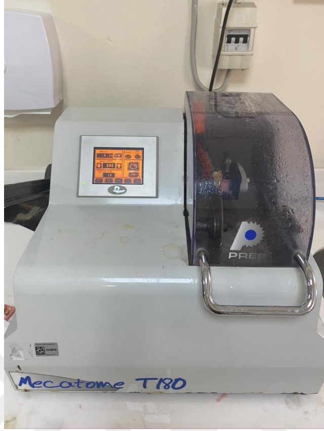
Şekil 3.2. Dentin bloklarının oluşturulduğu Mecatome T180 Cihazı
