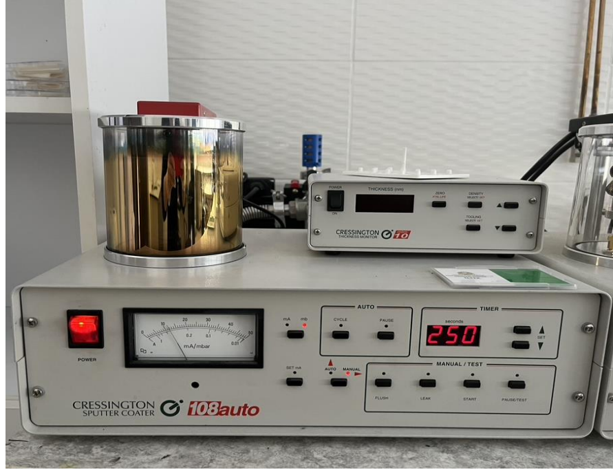
Şekil 3.11.- Kurutulan örneklerin incelenecek yüzeylerine havasız ortamda altın-paladyum tabaka kaplanması.
