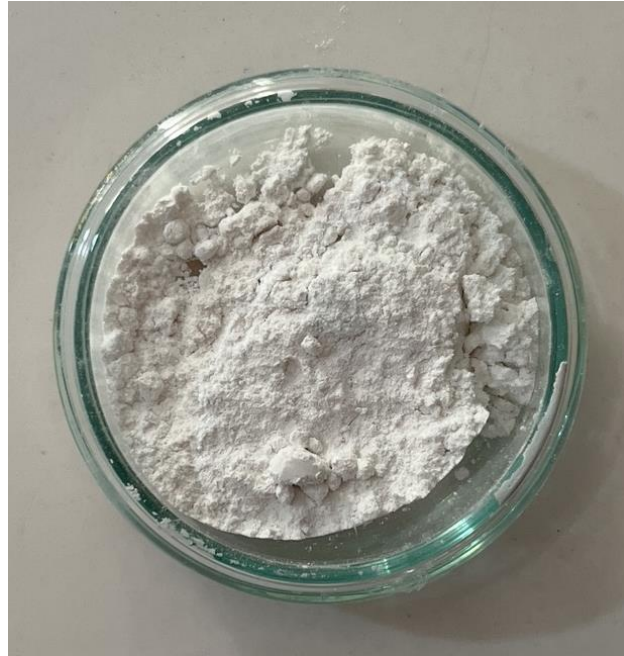
Şekil 3.8. Kalsiyum Hidroksit + 7% biyoaktif cam
