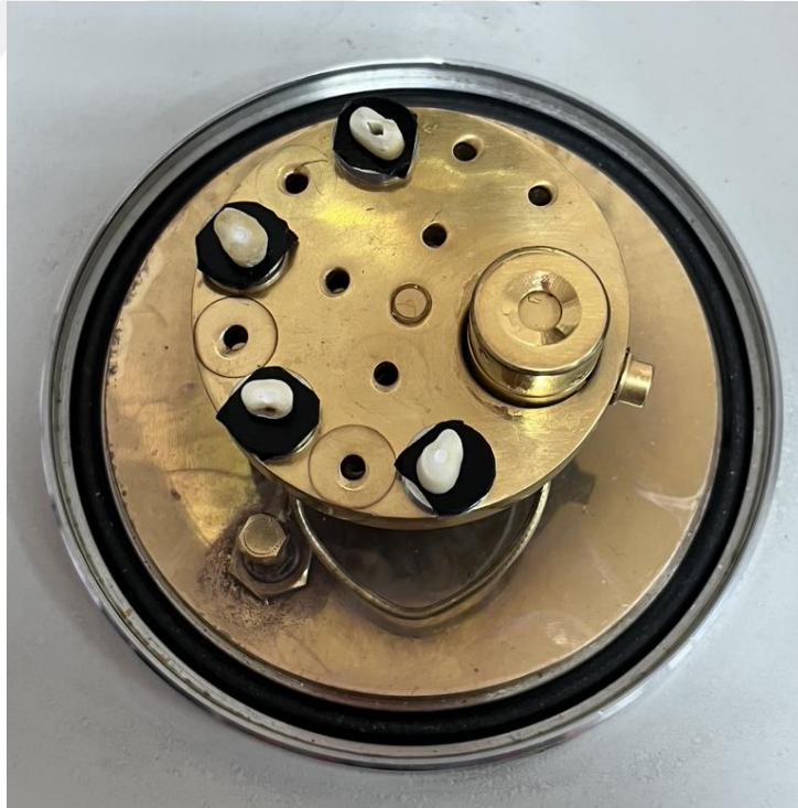
Şekil 3.12 Örneklerin altın-paladyum tabaka ile kaplanması için cihaz parçası üzerine dizilimleri.
