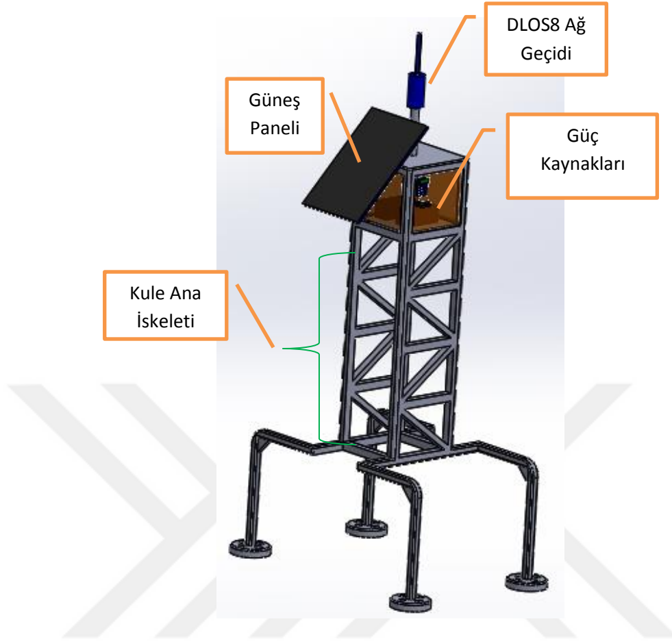
Şekil 3.19. SOLİDWORKS DLOS8 Ağ Geçidi Kule Tasarımı
