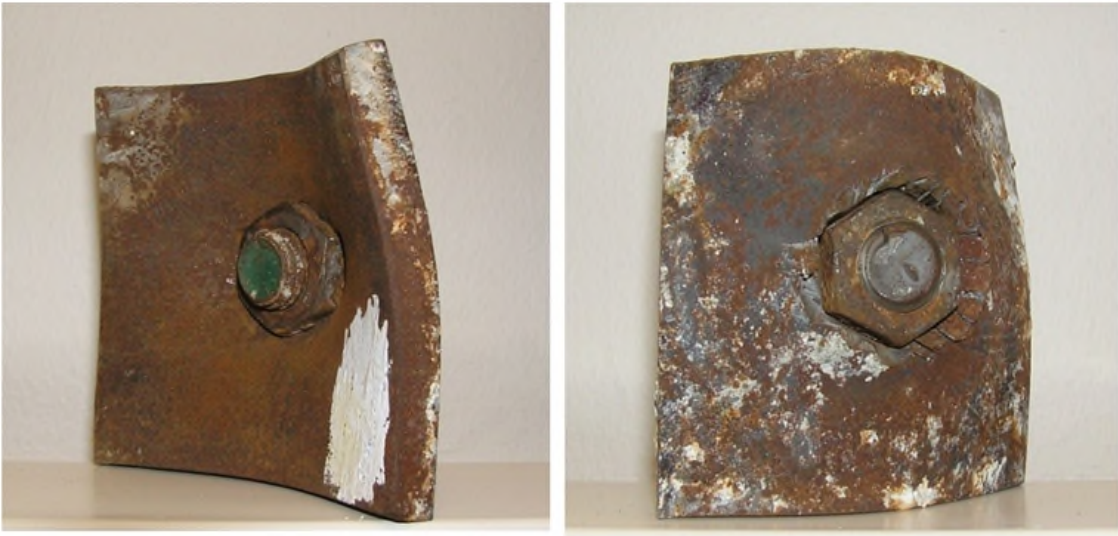
Şekil 2.7: Sahada basınç altında yenilen düz bulon plakalarının ön ve arka yüzleri (Li, 2017).
