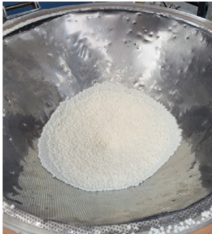
Şekil 3.16: Hammaddenin kurutma sonrası ve eritme öncesindeki granüler hali.
