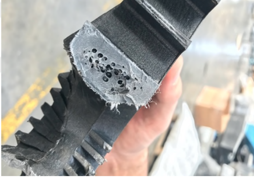
Şekil 3.6: Kırılan numunenin içindeki hava boşlukları.
