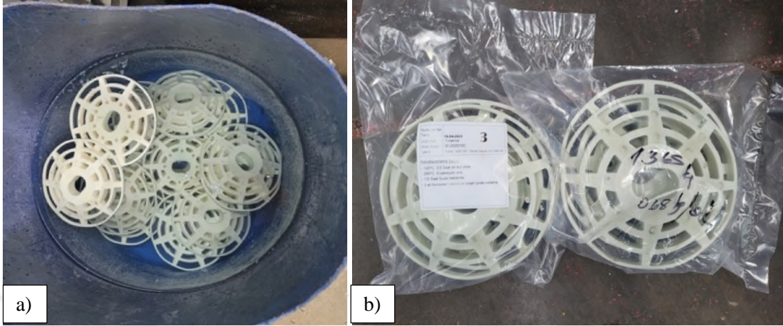
Şekil 3.17: a) Enjeksiyon sonrası soğuk su havuzuna atılan numuneler b) kürlenme prosedürü.
