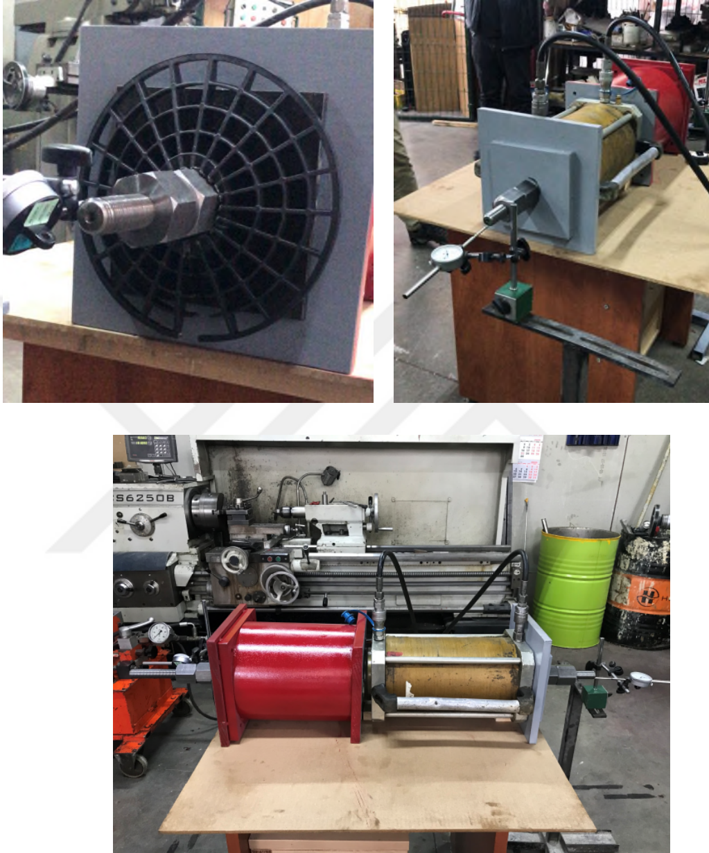
Şekil 3.2: Çekme testleri için kurulmuş test düzeneği.
