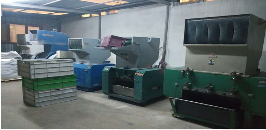
Şekil 1.18. İşletmede Bulunan Kırma Bölümü ve Kırma makineleri
