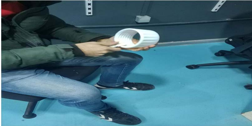
Şekil 1.21. İşletmede Kullanılan Maket Bıçağı ile Çapak Alınma Örneği
