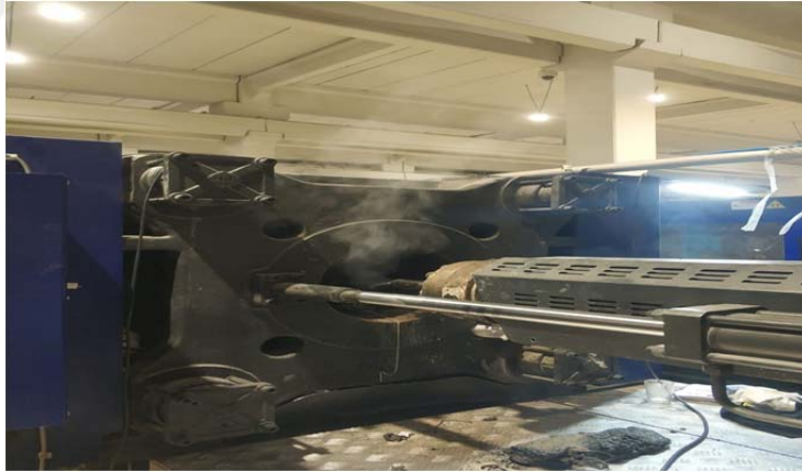
Şekil 1.20. İşletmede kullanılan enjeksiyon makinelerinde polimer dumanı örneği.
