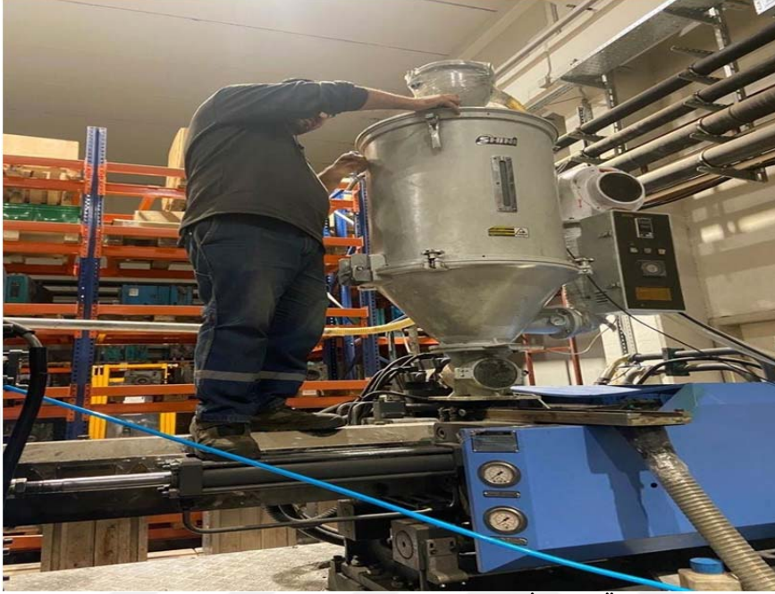
Şekil 1.22. Tesiste Hammadde Silosunun Temizlenme İşlemi Örneği
