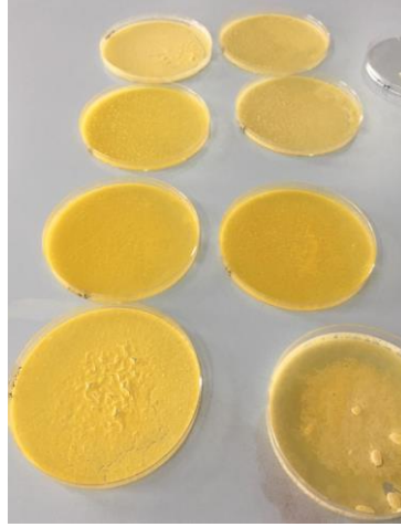
Resim 4: ZYF Kuruma Sürecinde Meydana Gelen Çatlamalar
