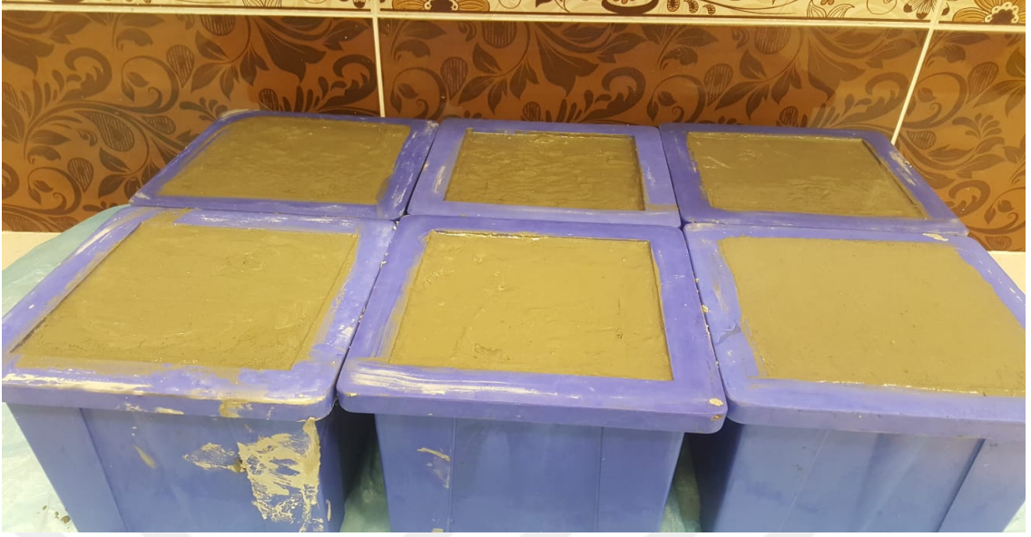
Şekil 3.12. Beton Harcının Kalıplara Konulması
