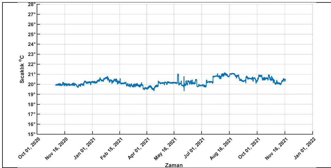
Şekil 6.19: Veri merkezi ortalama iç ortam sıcaklığı değişimi.
