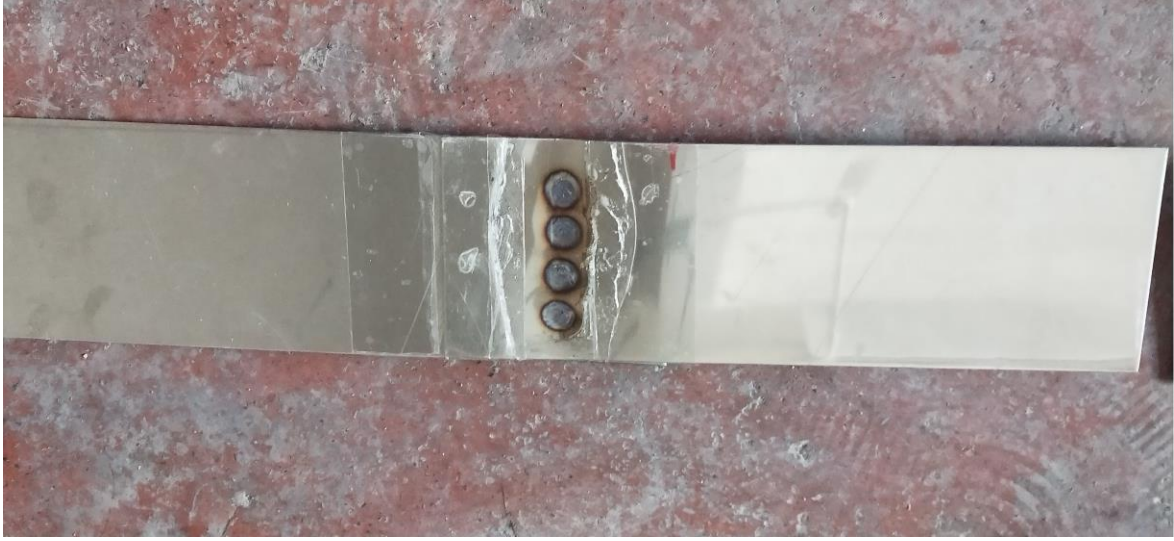
Şekil 4. 18. 0.8 mm kalınlıktaki paslanmaz çelik sac levhaların yatay desenli kaynaklı birleştirilmiş örneği
