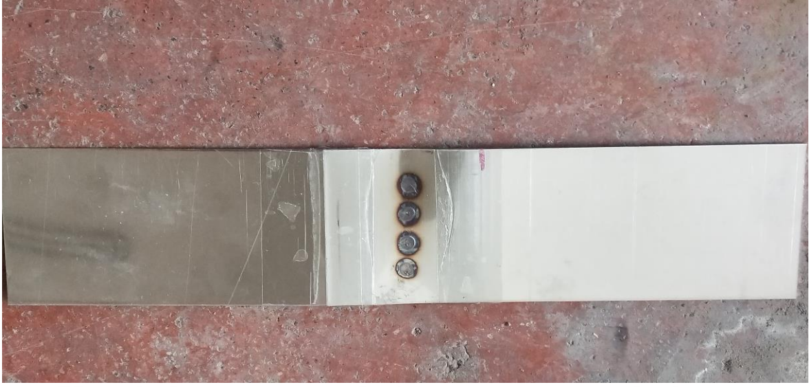
Şekil 4. 6. 0.5 mm kalınlıktaki paslanmaz çelik sac levhaların yatay desenli kaynaklı birleştirilmiş örneđi
