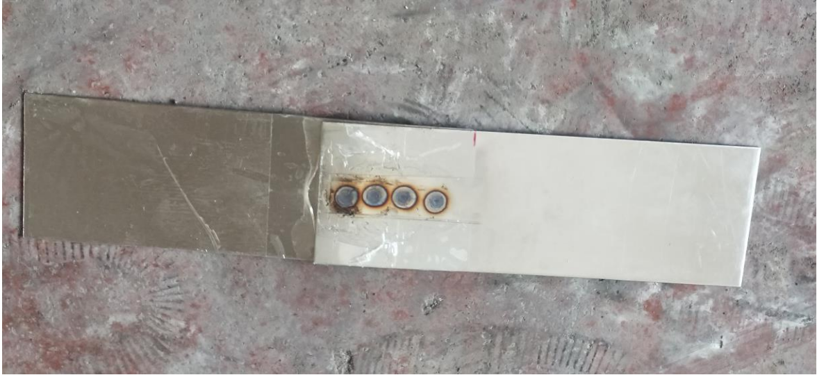
Şekil 4. 9. 0.7 mm kalınlıktaki paslanmaz çelik sac levhaların düşey desenli kaynaklı birleştirilmiş örneği
