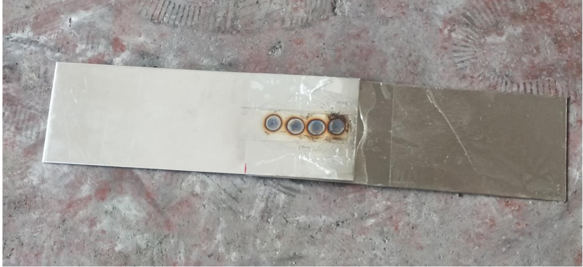
Şekil 4. 3. 0.5 mm kalınlıktaki paslanmaz çelik sac levhaların düşey desenli kaynaklı birleştirilmiş örneği
