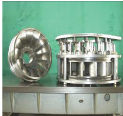
Şekil 2.9. Francis Tipi Türbin Parçaları [7]
