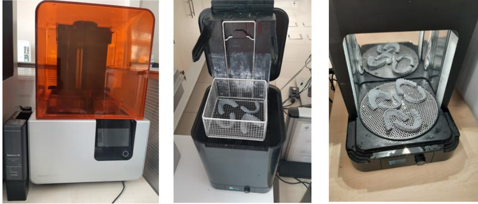
Resim 3.4. SLA 3B yazıcıdan üretilen modellerin üretim sonrası işlemleri
