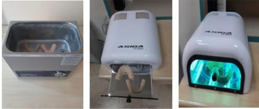
Resim 3.10. DLP 3B yazıcıdan üretilen modellerin üretim sonrası işlemleri
