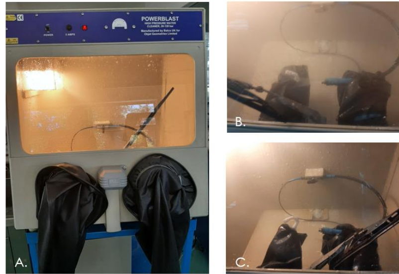
Resim 3.7. PolyJette üretilen modellerin atıklardan uzaklaştırılması
