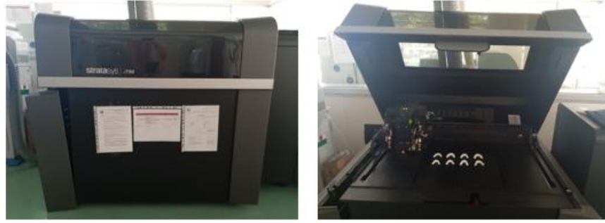
Resim 3.6. PolyJet 3B yazıcıda model üretimi aşaması
