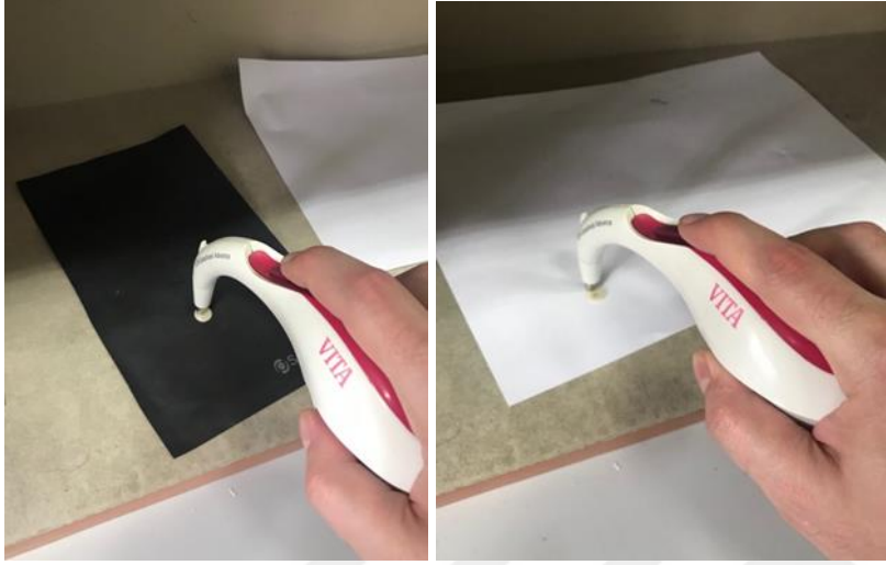
Resim 3.11. Örneklerin translüsenesi ölçümlerinin yapılması
