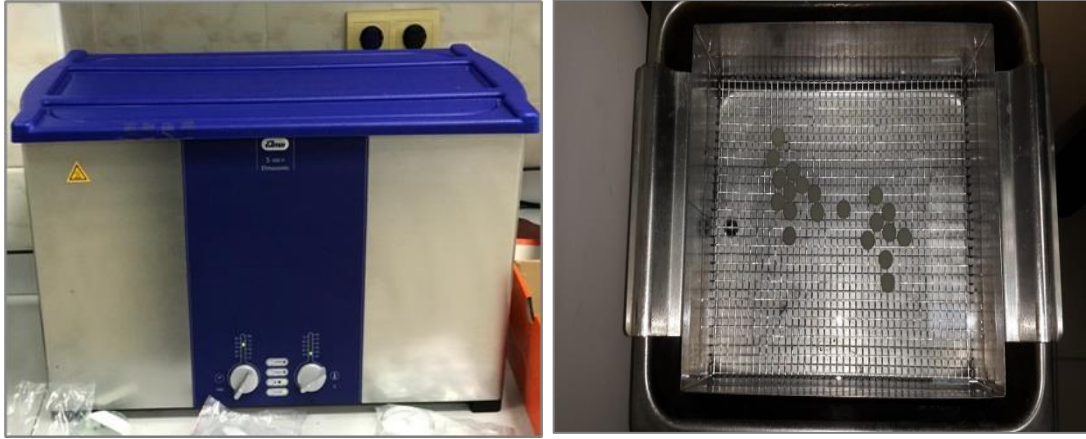
Resim 3.8. Yüzeysel işlemleri uygulanan örneklerin ultrasonik banyoda temizlenmesi
