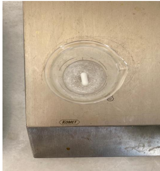
Şekil 3.4. Stronsiyum Ranelat tozunun PVA içinde homojenize edilmesi
