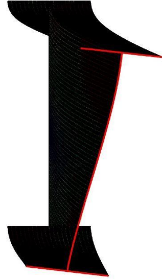
Şekil 6.36. W44x230 en kesitli 21.5 m uzunluğundaki kirişin analiz sonrası kesit görünüşü
