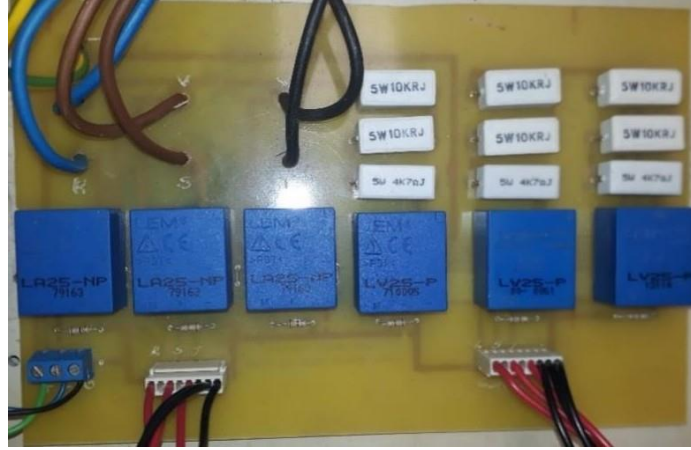
Şekil 5.5 Akım ve gerilim sensör devresinin fotoğrafı.
