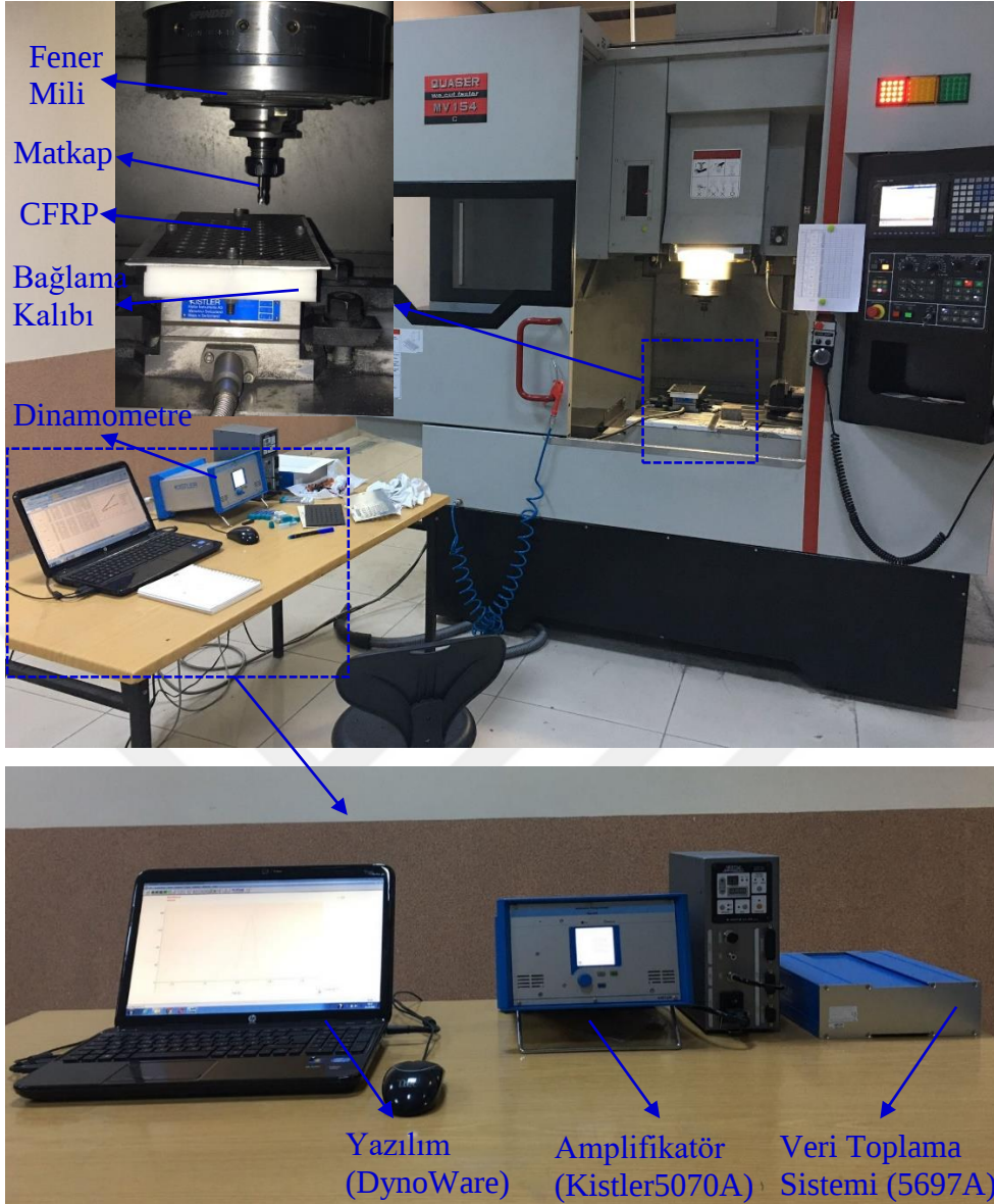
Şekil 3.3: Quaser MV154C dik işleme merkezi, kuvvet ölçüm dinamometresi ve bileşenleri.
