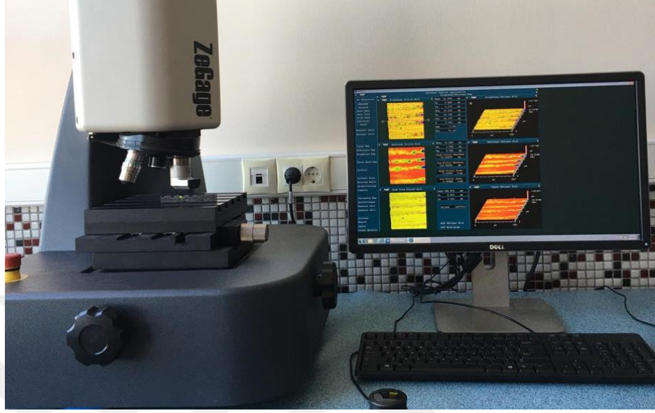
Şekil 3.7: Yüzey pürüzlülüğü ölçümünde kullanılan temazsız optik profilometre.
