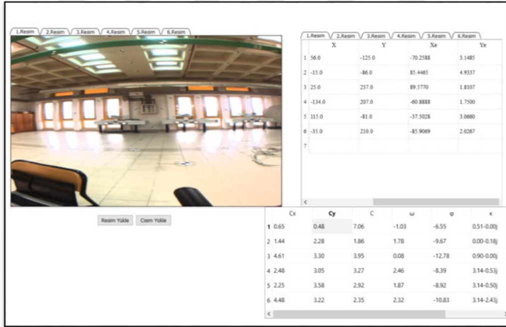
Şekil 3.25: Bir numaralı resim için equidistant ve iç yöneltme ve dış yöneltme elemanları
