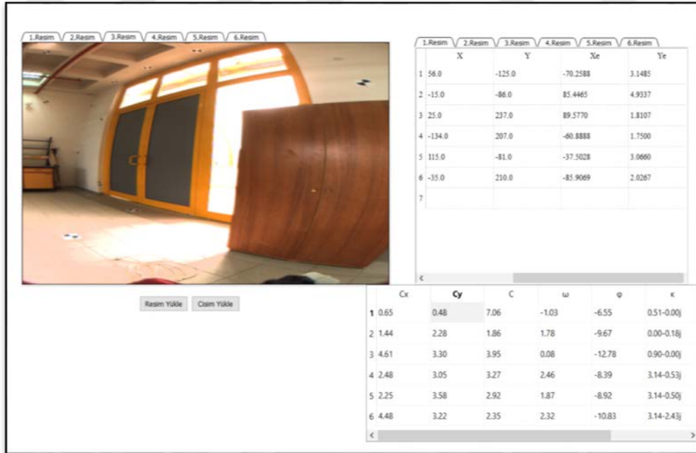
Şekil 3.27: Üç numaralı resim için equidistant ve iç yöneltme ve dış yöneltme elemanları
