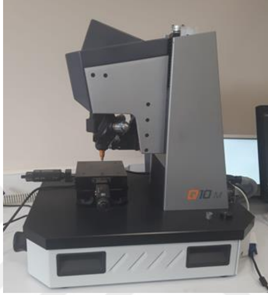
Şekil 2.4. Qness Q10M markalı Mikro Sertlik Cihazı
