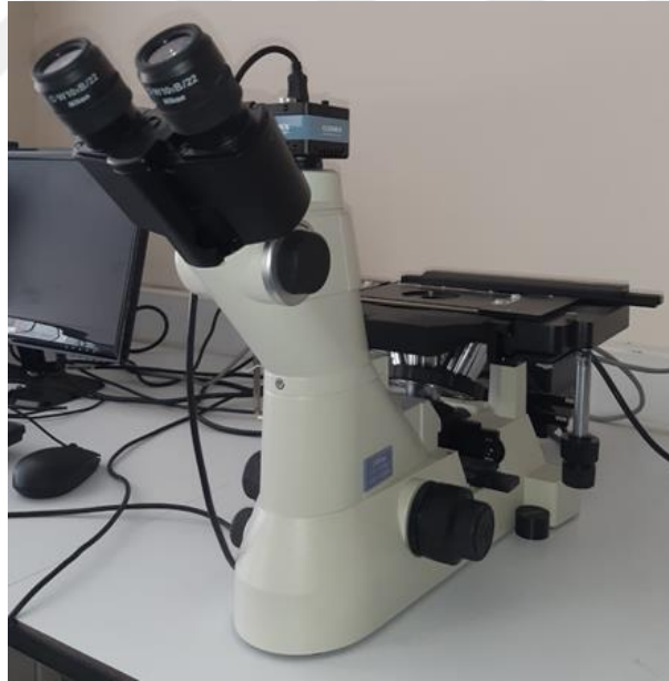
Şekil 2.3. Nikon Eclipse MA 100 optik mikroskop
