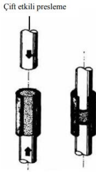
Şekil 1.6. Metal kalıpta çift yönlü sıkıştırma
