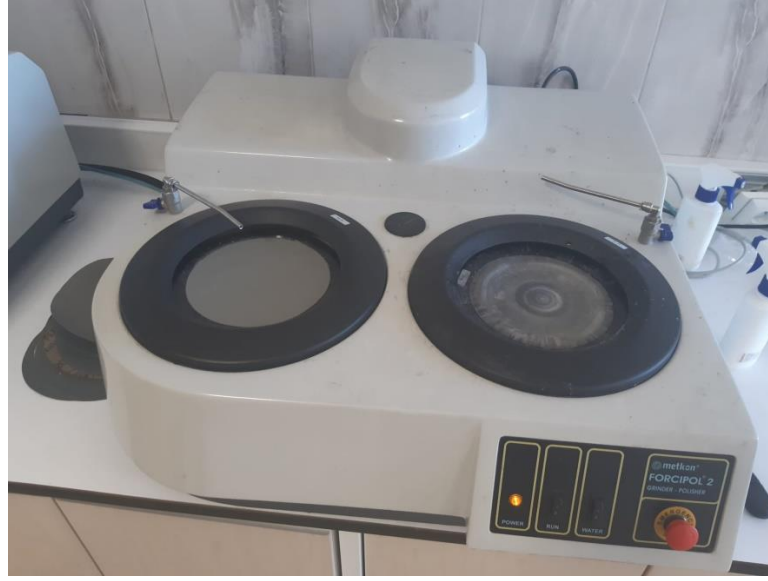
Şekil 2.2. Zımparalama ve Parlatma cihazı
