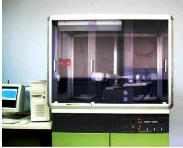
Şekil 2.6. Rigaku marka RadB model XRD cihazı
