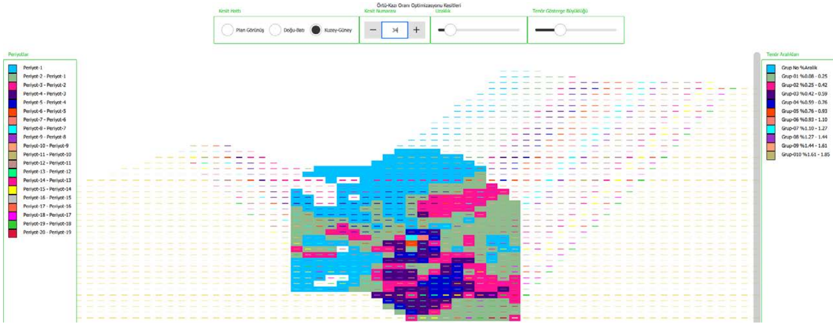
Şekil 4.17 Tungsten madeni verisi Kuzey-Güney yönünde cevherleşme ve tenör dağılımı kesit görünüşü
