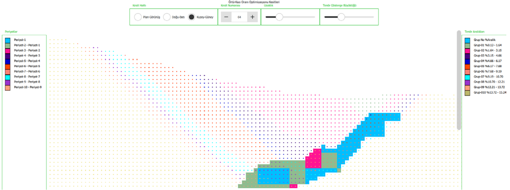
Şekil 4.13 Altın madeni verisi Kuzey-Güney yönünde cevherleşme ve tenör dağılımı kesit görünüşü
