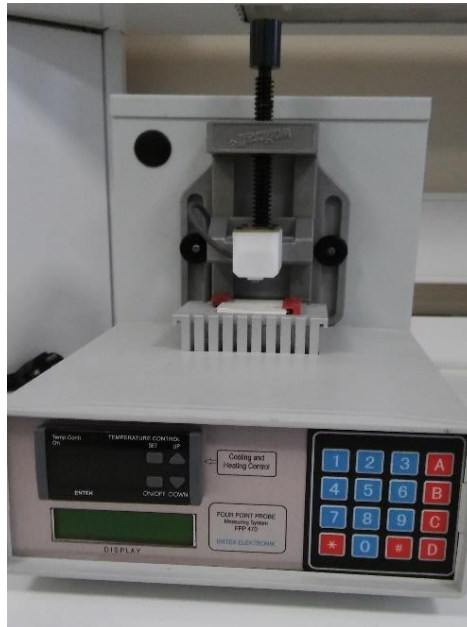
Şekil 3.3 Entek FPP 470 dört nokta probu
