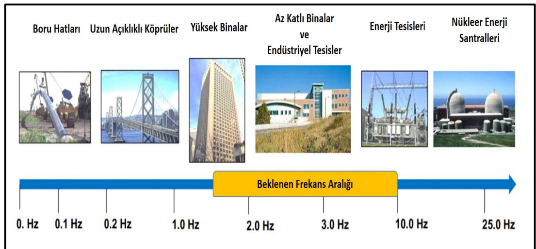
Şekil 4.1: Mühendislik yapılarının beklenen frekans aralığı.
