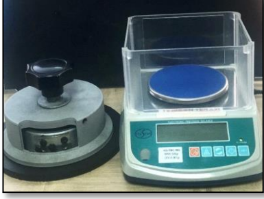
Şekil 3.4. Kumaş birim alan kütle ölçüm aleti
