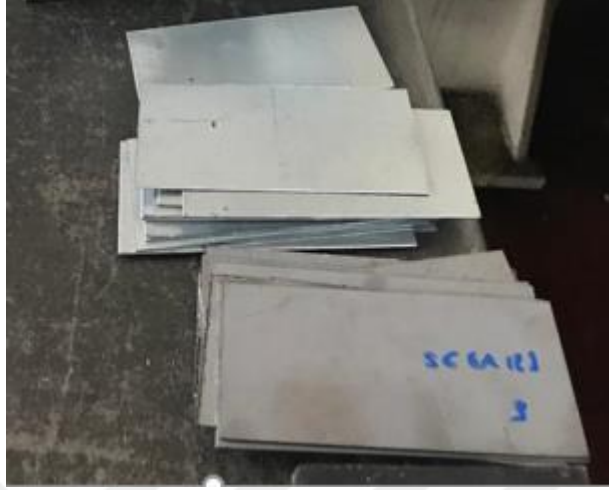
Şekil 6.13. U bükme numuneleri.
