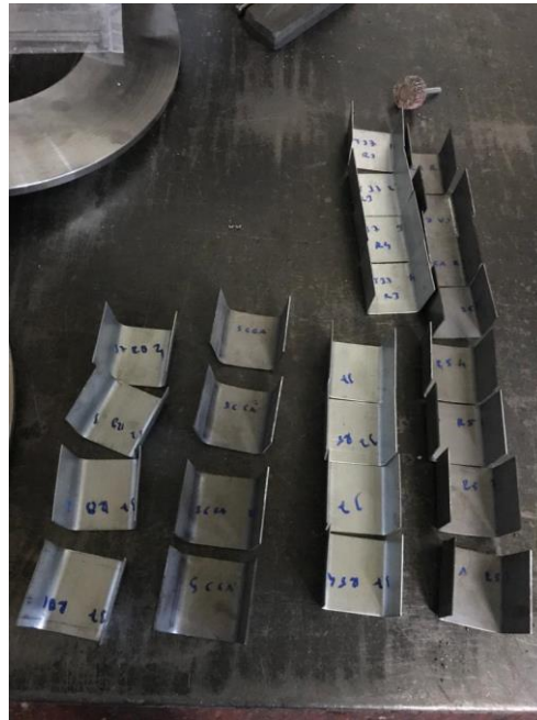
Şekil 7.8. U büküm şekillendirilmiş numuneler.
