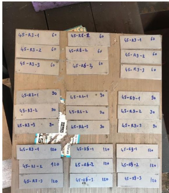
Şekil 6.16. V bükme numuneleri.
