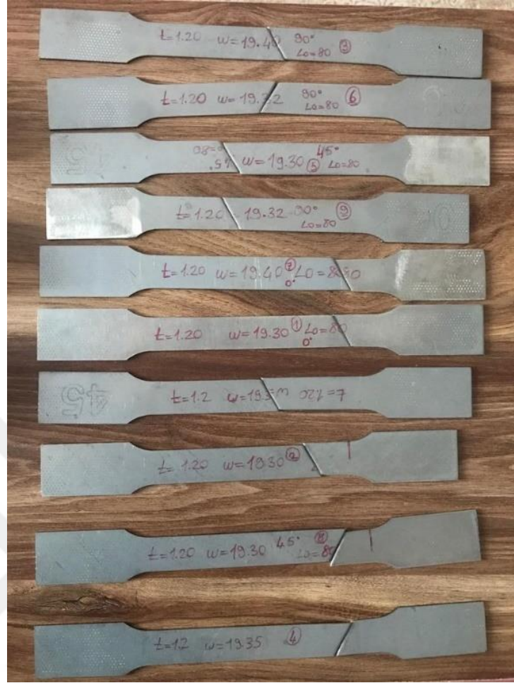
Şekil 6.4. Test sonrası numunelerin görünüşü.
