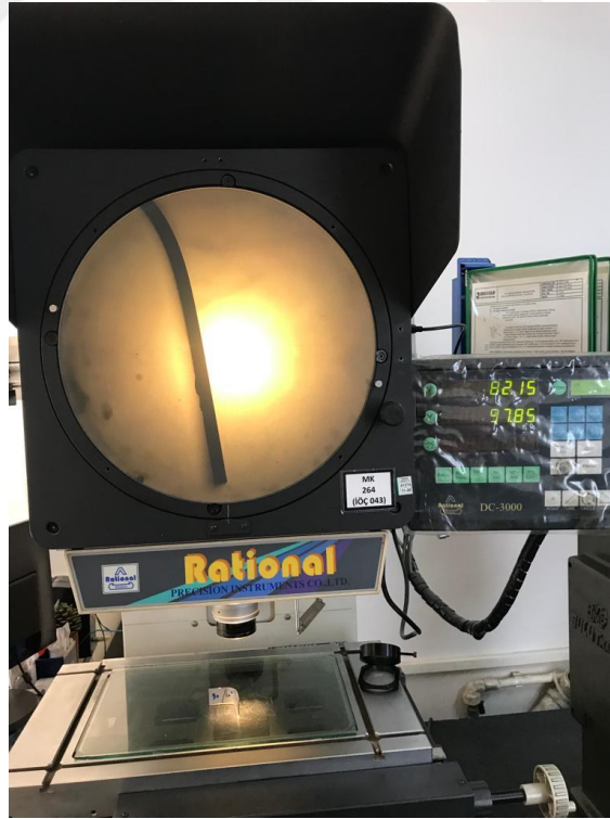
Şekil 6.18. Lazer optik projeksiyon cihazında geri yaylanmanın ölçümü.
