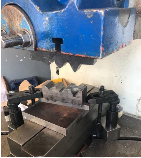
Şekil 6.15. Kalıbın adaptör parça ile prese bağlanması.
