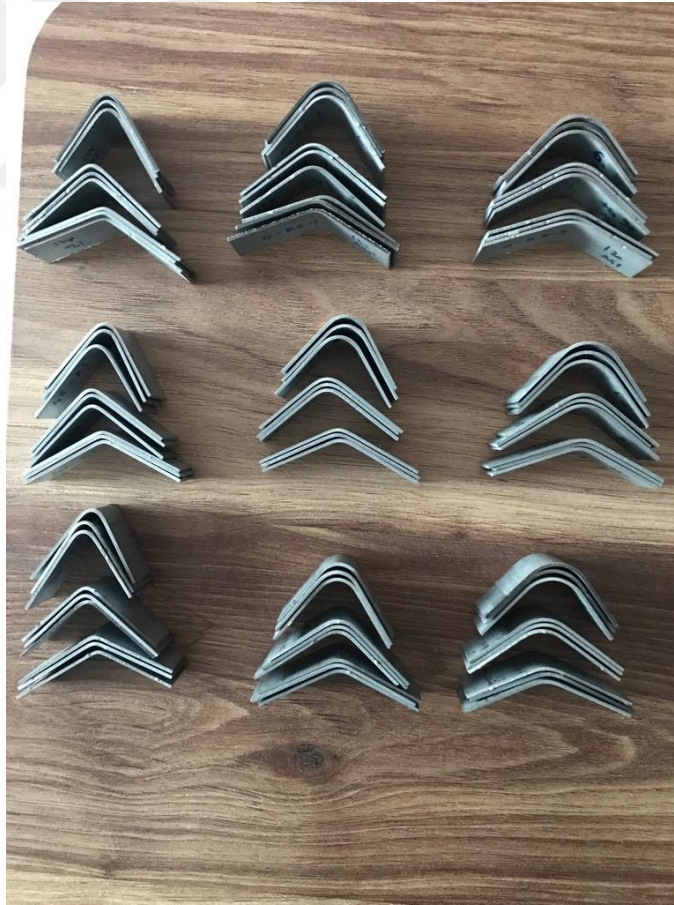
Şekil 7.1. V bükme kalıbında şekillendirilmiş numuneler.
