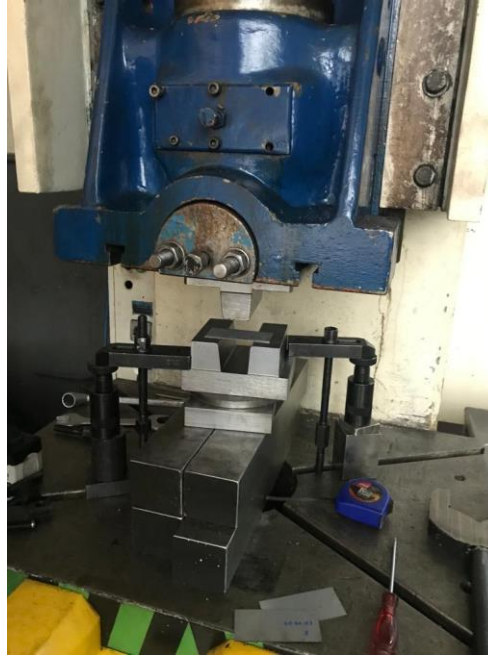
Şekil 6.12. Kalıbın adaptör parça ile prese bağlanması.
