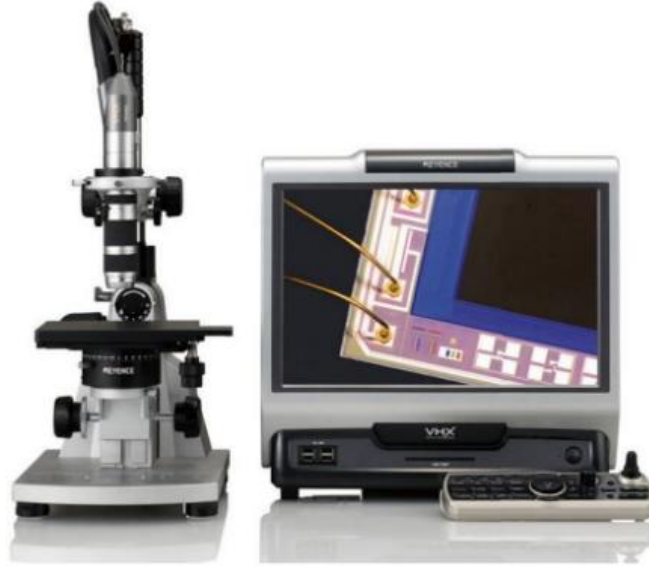
Şekil 3.19. Keyence VH-X 1000 Ölçüm Mikroskobu
