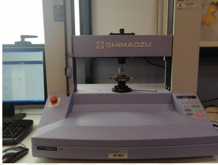
Resim 25: Universal test cihazı (Shimadzu, AGS-X, Japonya)
