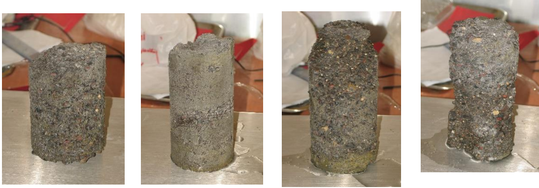
Şekil 32. Başarısız enjeksiyon örnekleri
