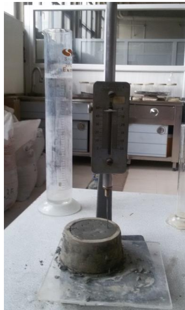
Şekil 27. Vicat iğnesi deney aleti ve yapılışı
