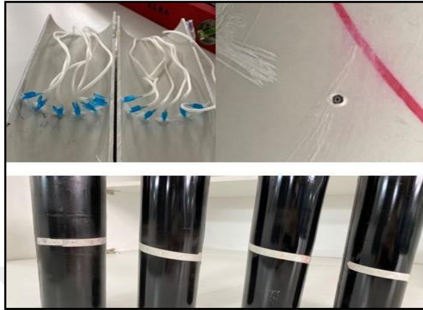
Şekil 2.4. Üretilen numunelerde bulunan basınç okuma delikleri
