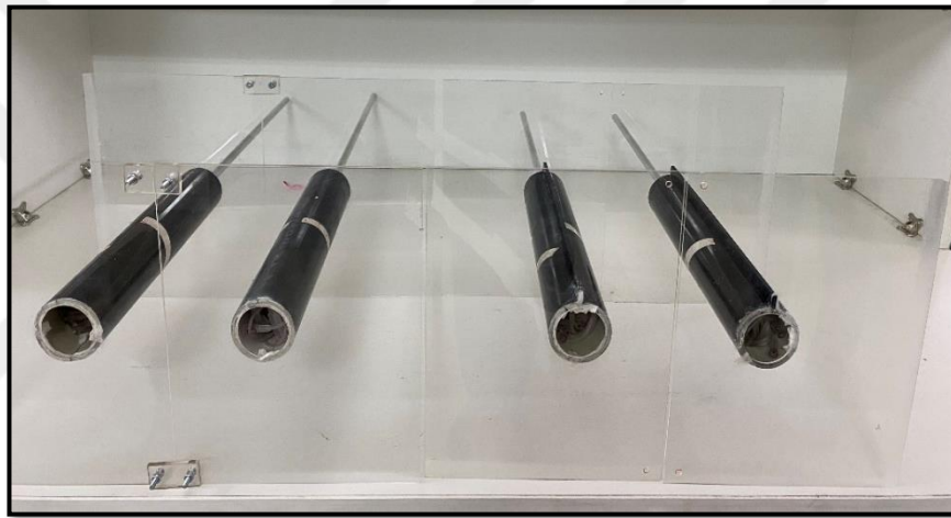
Şekil 2.3. Üretilmiş olan başlıklı ve başlıksız silindir numuneler
