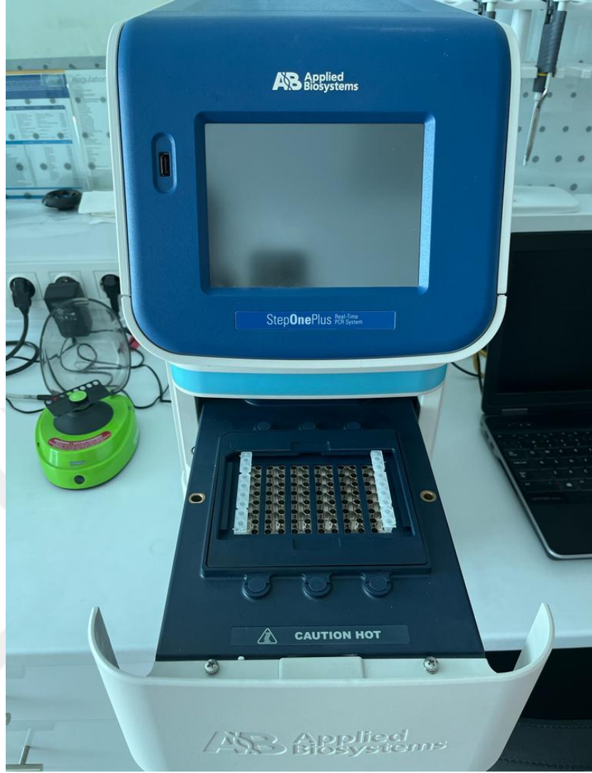
Şekil 3.7: Real time PCR için kullandığımız StepOne Plus qRT-PCR, Applied Biosystem cihazı
