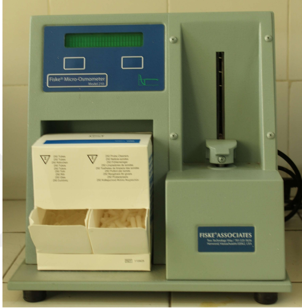
Şekil 3.6: Seminal plazma ozmolalitesi ölçümü yapılan cihaz.
