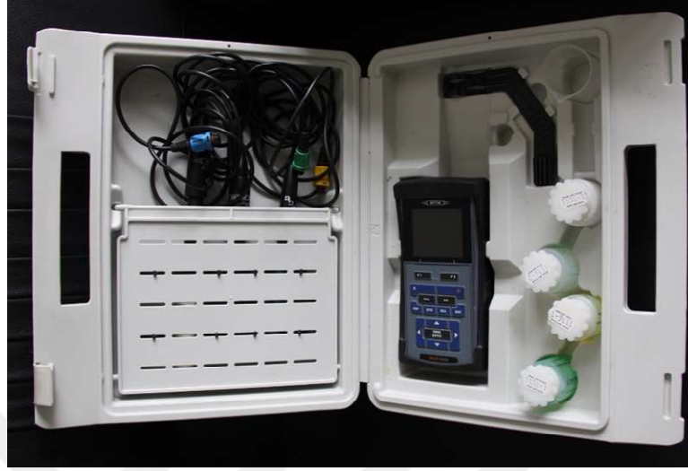
Şekil 3.4: Su sıcaklığı, çözülmüş oksijen ve pH ölçümü yapılan cihaz.
