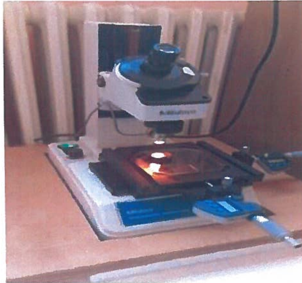
Şekil 4.5. Aşınma şeridi genişliği ölçümünde kullanılan takımcı mikroskobu.
