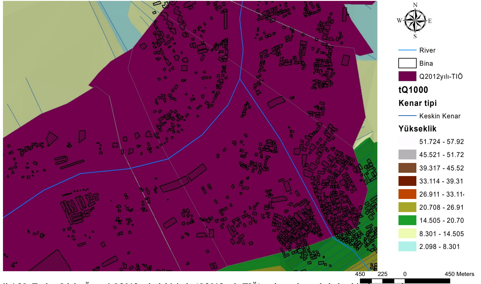
Şekil 4.39. Taşkın Islahı Öncesi Q2012 yılı debisinde (Q2012 yılı-TIÖ) taşkın sahasında kalan binalara örnek
