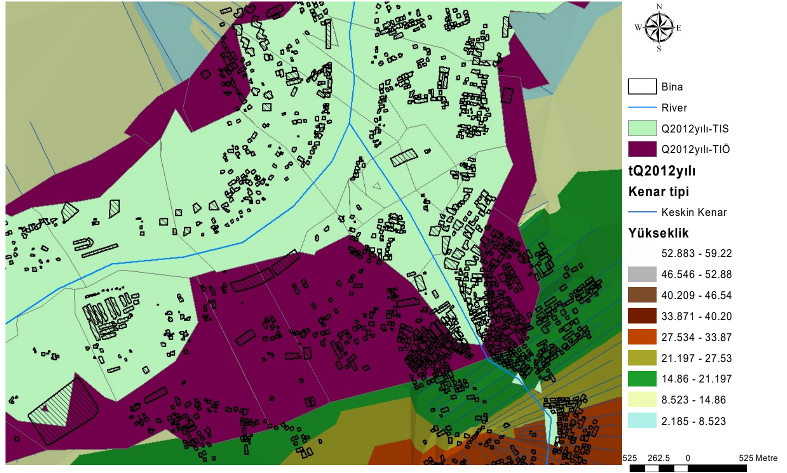
Şekil 4.42. Taşkın Islahı Sonrası Q2012 yılı debisinde (Q2012 yılı-TIS) taşkın sahasında kalan binalara örnek
