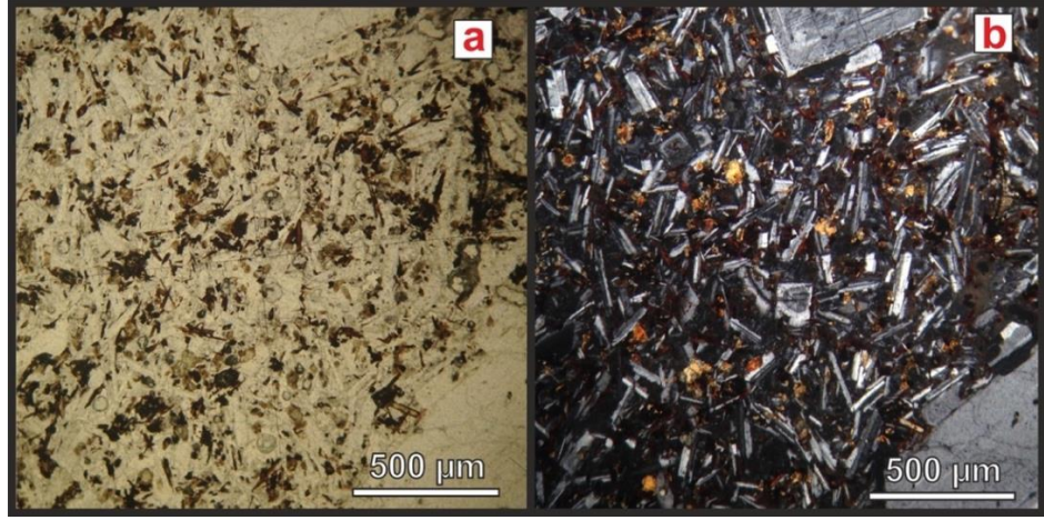
Şekil 3.1: Küçük Hasandağ'ın bazaltik andezitlerinde gözlenen pilotaksitik doku (Örnek no: ZS6, a-Tek nikol, b-Çift nikol).
